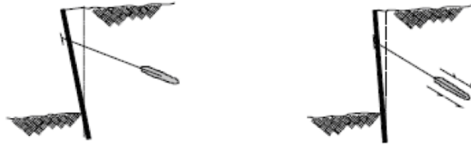
Şekil 5.8: Enjeksiyon-tendon ve zemin-enjeksiyon sıyırılması.
