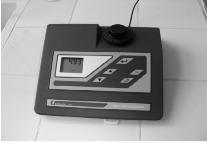
Şekil 5.7. . Bulanıklık ölçümleri HF Scientific Türbidimetre Cihazı
