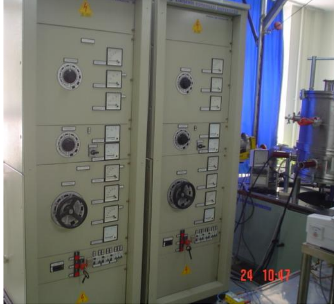
Şekil 5.5 Katot akımı güç kaynağı ve anot potansiyeli güç kaynağı.
