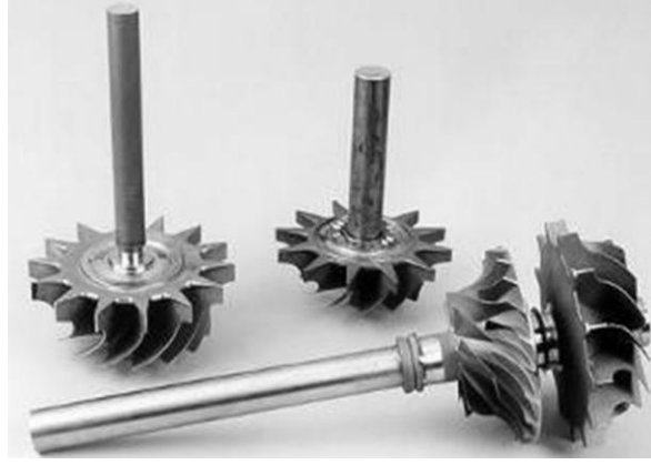
Şekil 4.14 Sürtünme kaynağı ile imal edilmiş uçak parçası (Çelik, 2008).
