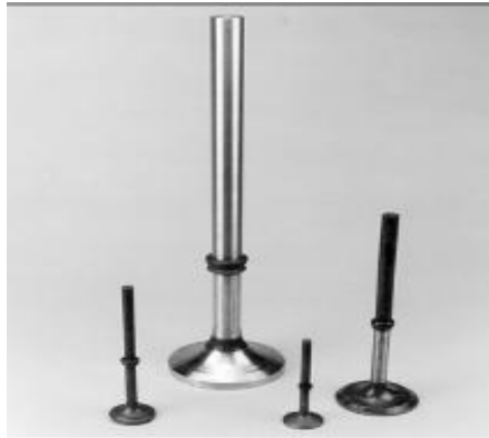
Şekil 4.11 Sürtünme kaynağı ile imal edilmiş egzoz subapları ( www.mtiwelding.com ).
