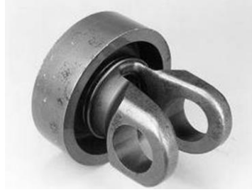
Şekil 4.15 Sürtünme kaynağı ile imal edilmiş dizel motor pistonu (www.mtiwelding.com).
