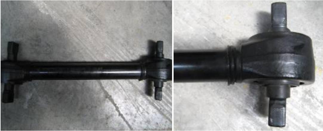
Şekil 4.13 Ticari araçlarda sürtünme kaynağı uygulanmış çeki kolları (www.mtiwelding.com).
