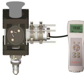
Şekil 5.2 QPD tutucusuna yerleştirilen güç kontrol cihazı.
