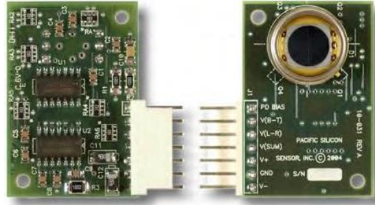
Şekil 6.1 Alınması planlanan QPD (QP50-6SD2).
