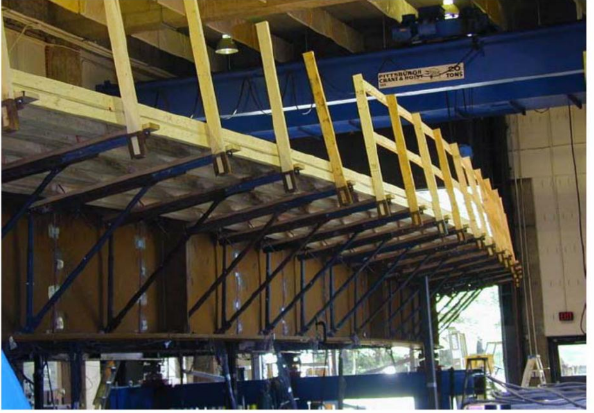
Şekil 2.8 Dış kirişe bağlanan konsollar (Jung, 2006).
