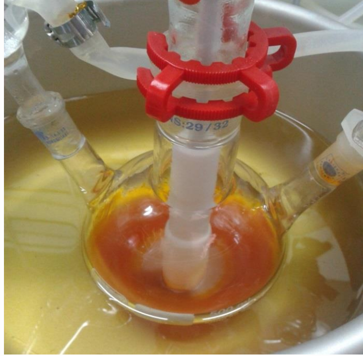
Şekil 3.3. Polimerizyon işleminin ilk aşamasındaki renk değişimi
