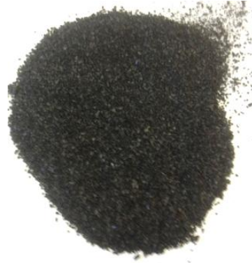
Şekil 6.2. H_3PO_4 kullanılarak üretilen aktif karbon
