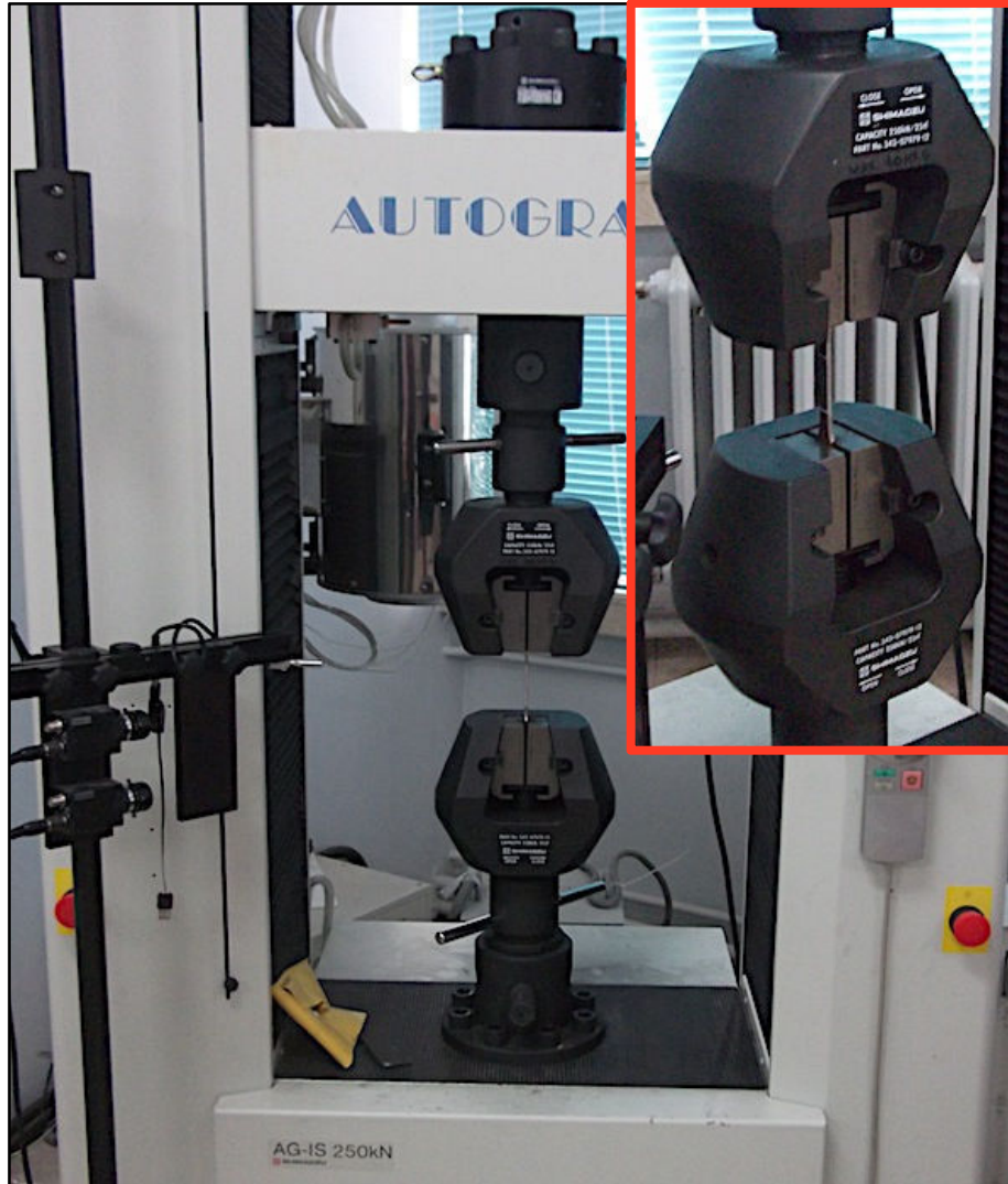
Şekil 5.1. Shimadzu AG-IS 250kN üniversal test cihazı
