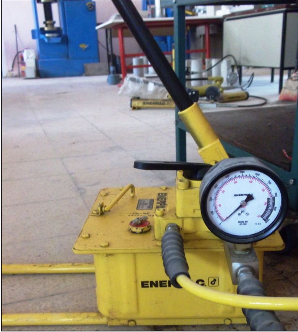
Şekil 5.8. ENERPAC P464 hidrolik pompa
