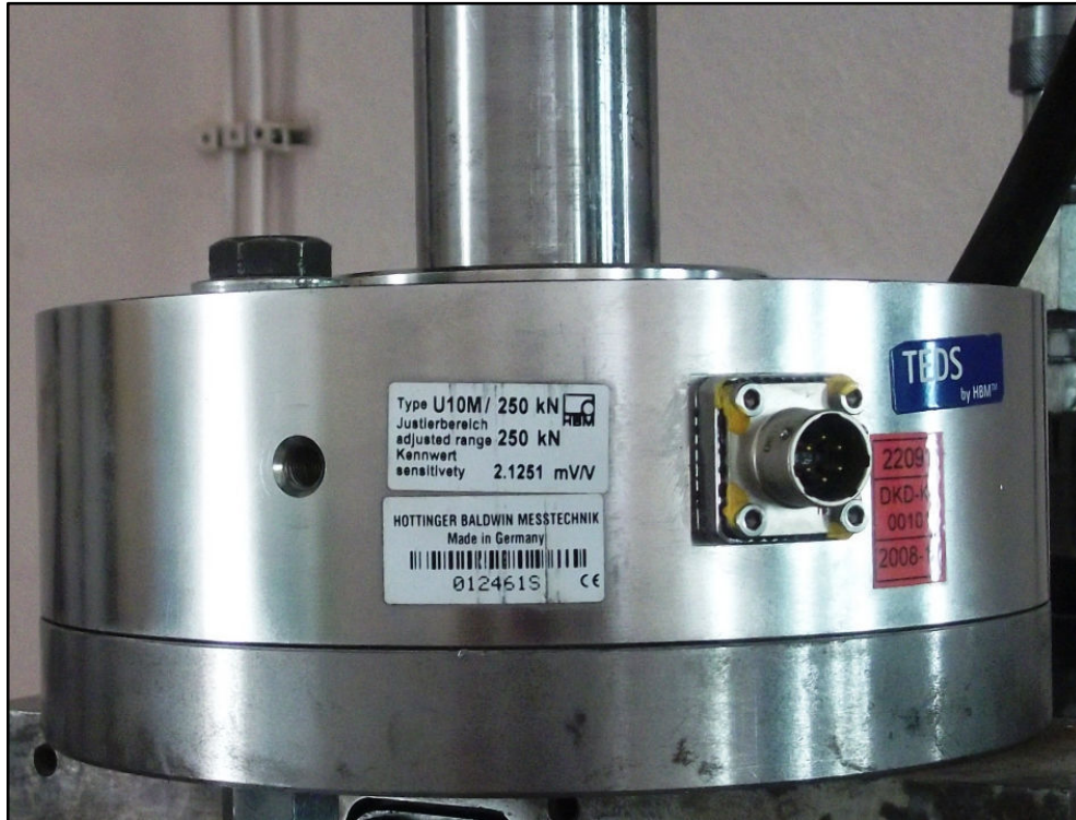
Şekil 5.4. U10M-250 kN load cell
