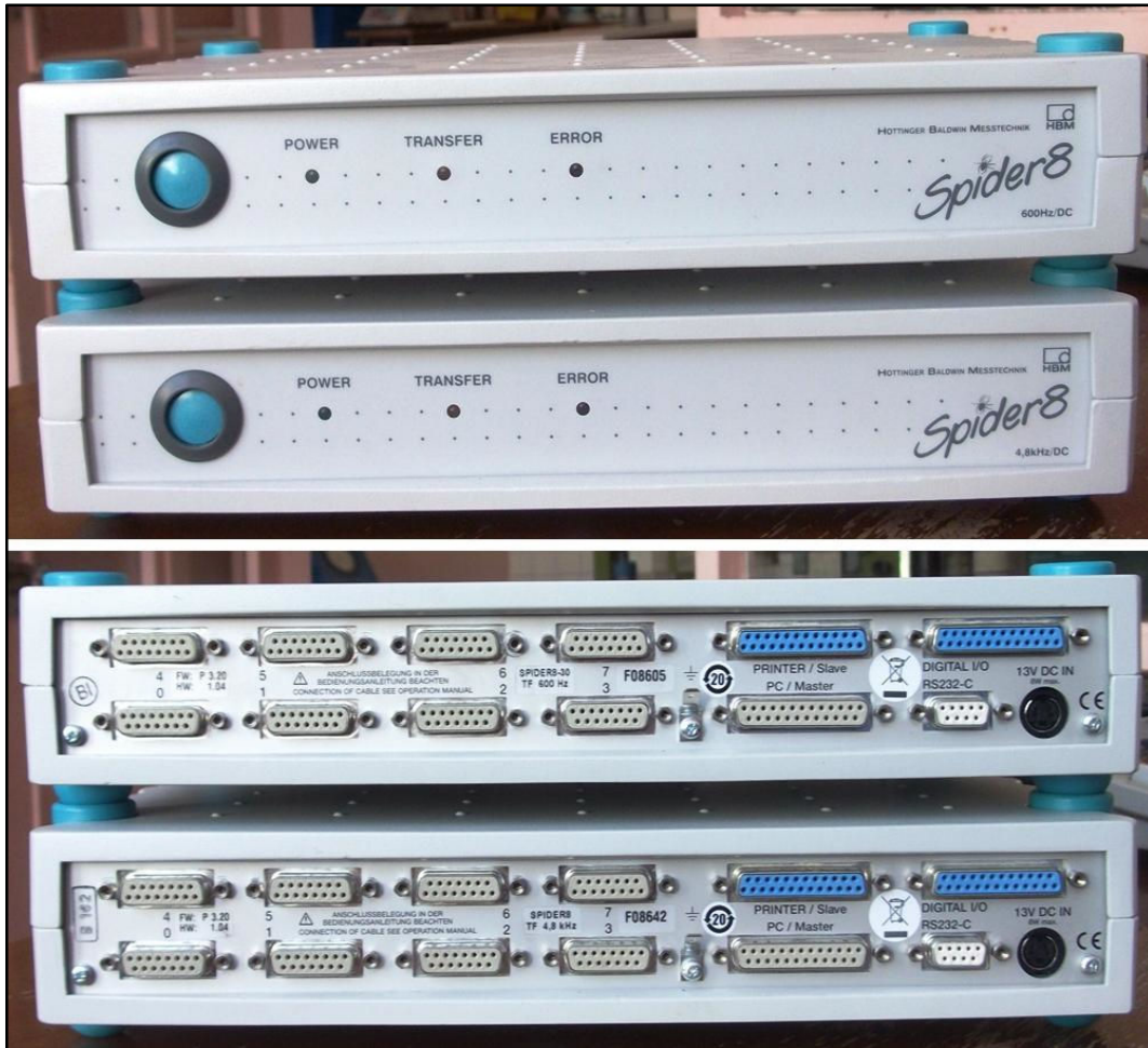
Şekil 5.2. Spider8-30 ve Spider8 veri toplama cihazları
