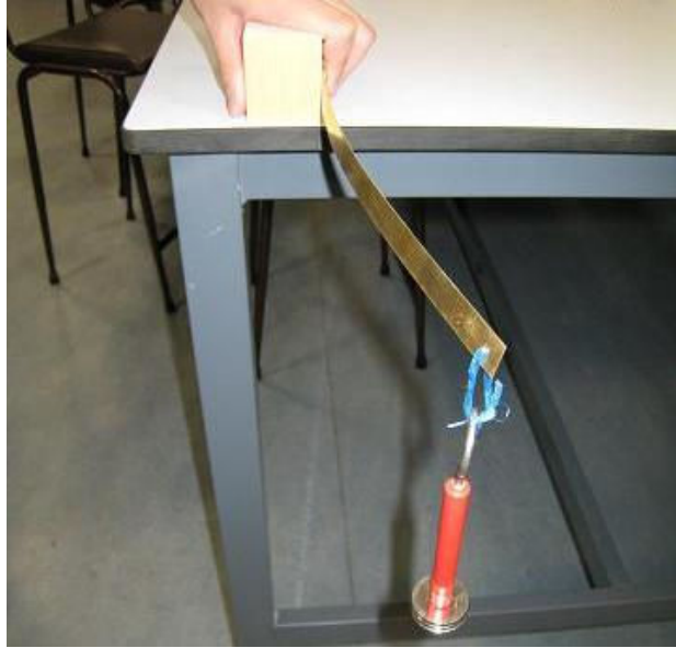
Şekil 2.1. Yanal burulmalı burkulma (Ji and Bell, 2008)
