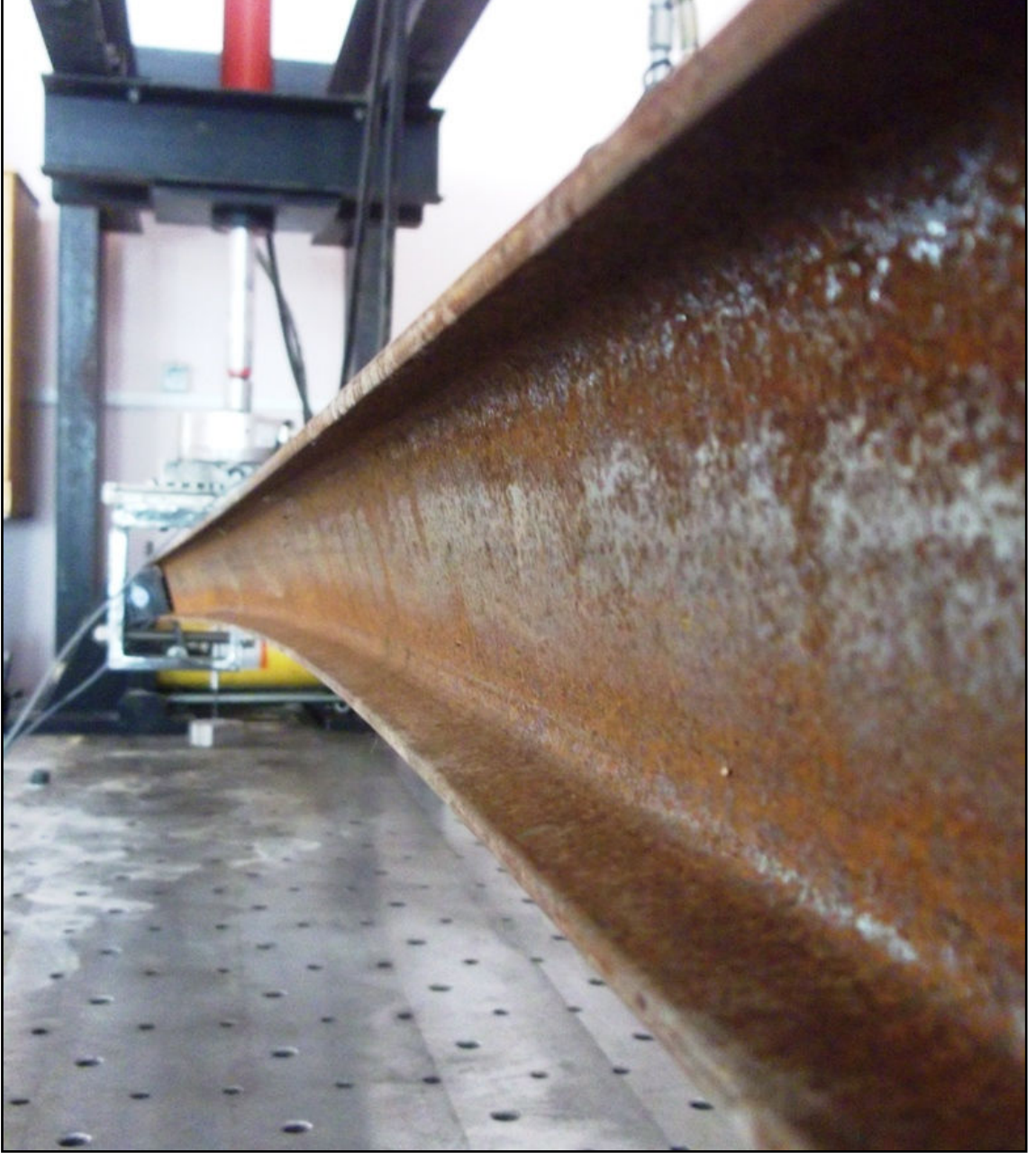
3 m uzunluğunda IPE100 kesitli konsol kirişin, alt başlığında yüklenmesi hali için yanal burulmalı burkulma durumu (ön görünüş)
