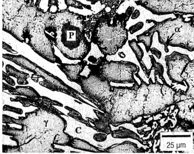
Şekil 2.7. 15Cr-3Mo beyaz dökme demir yapısı ( \gamma : östenit, C: ötektik karbürler, P: perlit ve \alpha : ötektik karbürleri çevreleyen martenzit) (Tabrett, et al., 1996).
