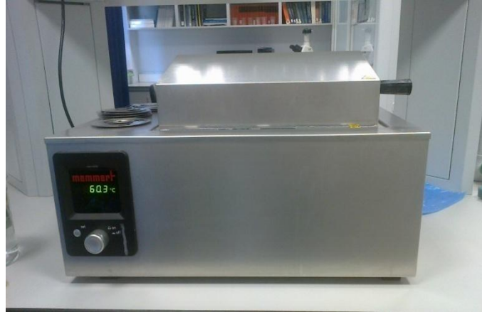
Şekil 5.5. Filmlerin kimyasal işleme tutulduğu banyo havuzu.
