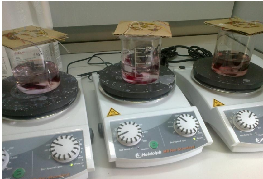
Şekil 5.6. Filmlerin kurutulmadan önce durulanmasında kullanılan manyetik karıştırıcılar.
