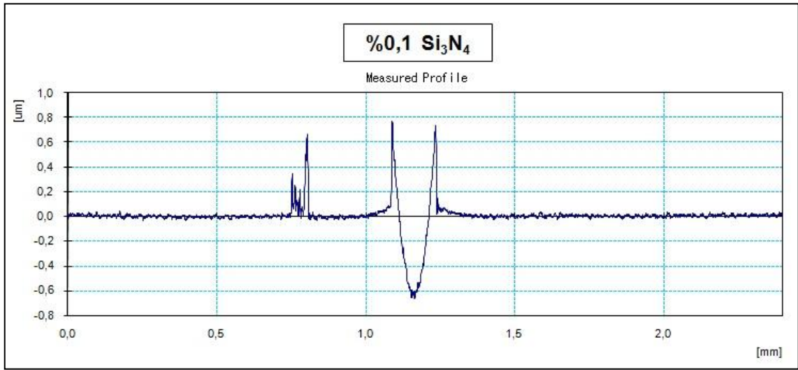
Şekil 5.48. %0,1 Si 3 N 4 katkılı yağ içinde yapılan Ball-on-disc deneyinde aşınma profili
