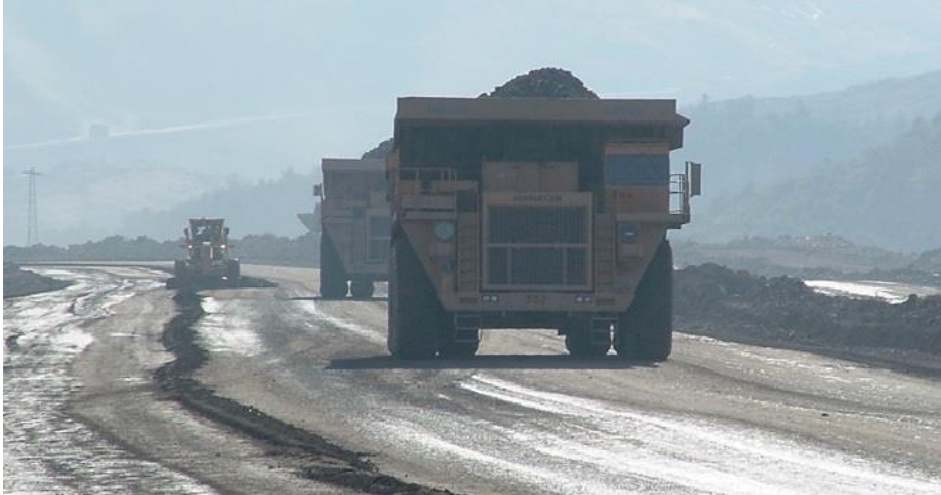
Şekil 4.22. İşletmede kullanılan Komatsu marka ağır iş kamyonları (www.eli.gov.tr)
