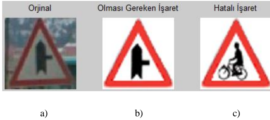
Şekil 4.62 ŞE yöntemine göre hatalı sınıflandırma; a) orijinal aday trafik işareti, b) olması gereken trafik işareti ve c) hatalı olarak bulunan trafik işareti
