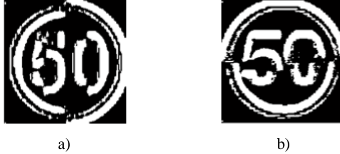
Şekil 3.11 Örnek resmin gradyan gösterimleri: a) yatay gradyan ve b) dikey gradyan
