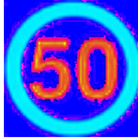
Şekil 3.20 Örnek resmin HSV renk uzayında görüntüsü.
