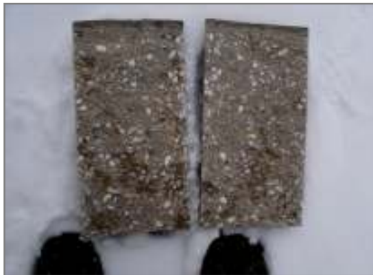
Şekil 6.14. Testi bitmiş silindir numune
