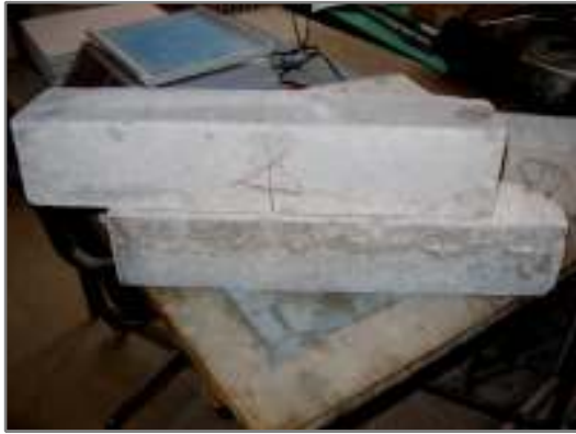
Şekil 6.33. Çelik Lif kullanılmış, kopmaya direnmiş kiriş numunesi
