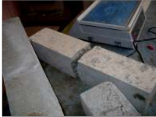
Şekil 6.32. Lifsiz elemanın kopmuş - ayrılmış hali
