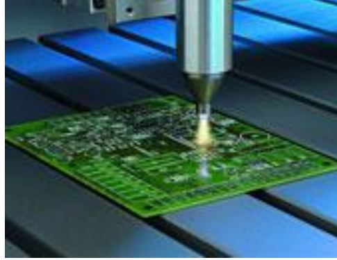
Şekil 3.9. Plazma jet ile elektronik kart temizliği ( www.plasmatreat.com , 03.06.2013).
