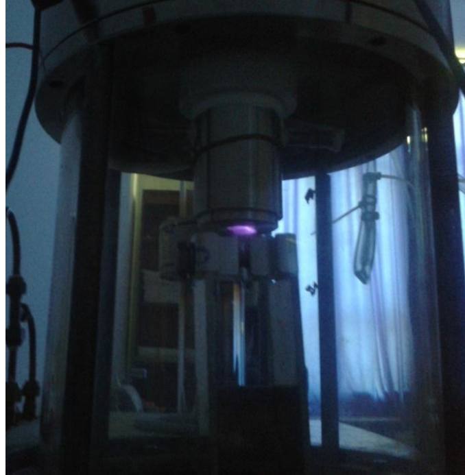
Şekil 4.7. Havanın akan DC post deşarj/plazma jet plazması.
