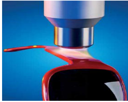
Şekil 3.10. Hassas bir materyal olan plastiğin atmosferik basınçta üretilen soğuk plazma ile temizlenmesi ( www.plasmatreat.com , 03.06.2013).
