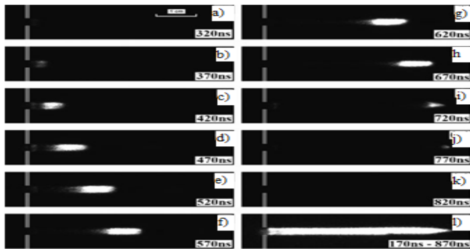
Şekil 3.5. Puls Plazma jet tarafından üretilen plazma atmaları (Lu and Laroussi, 2006).
