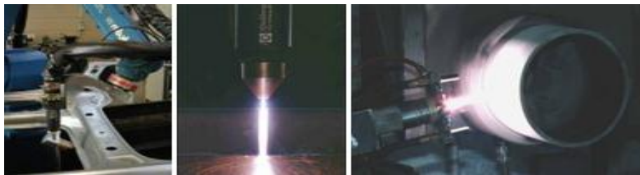
Şekil 3.6. Sıcak ark plazma jetleri (www.gordonenglan.co.uk, 08.06.2013).
