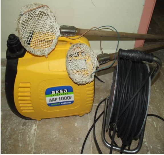
Şekil 2.2.a: AKSA marka jeneratörün modifiye edilmesiyle oluşturulmuş elektroşoker.
