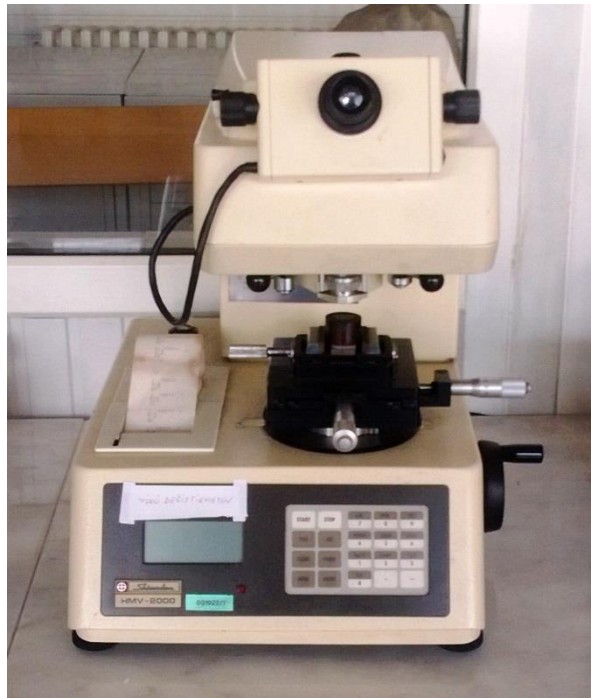
řekil 4.4 Shimadzu HMV-2000 mikro sertlik lüm cihazı
