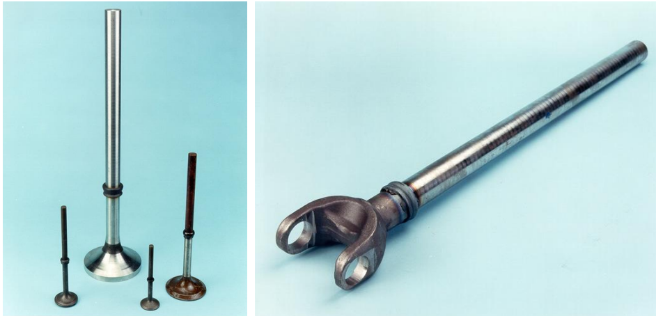
Şekil 3.8 Otomotiv endüstrisinde sürtünme kaynağı ile üretilen parçalar. ( www.mtiwelding.com )
