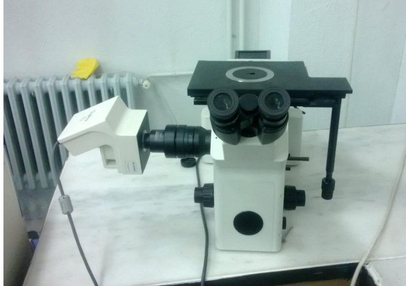
Şekil 4.3 Olympus GX51 optik mikroskobu ve buna bağlı ProgRes CFscan görüntü analizörü
