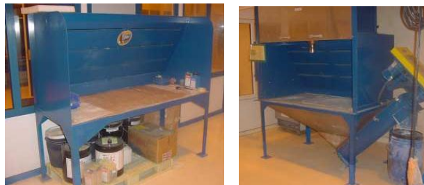
Şekil 4.7 (a) CODEP paket tozlarını hazırlama/karıştırma cihazı, (b) Mumlama makinesi, (c) Amonyum florür kurutma fırını
