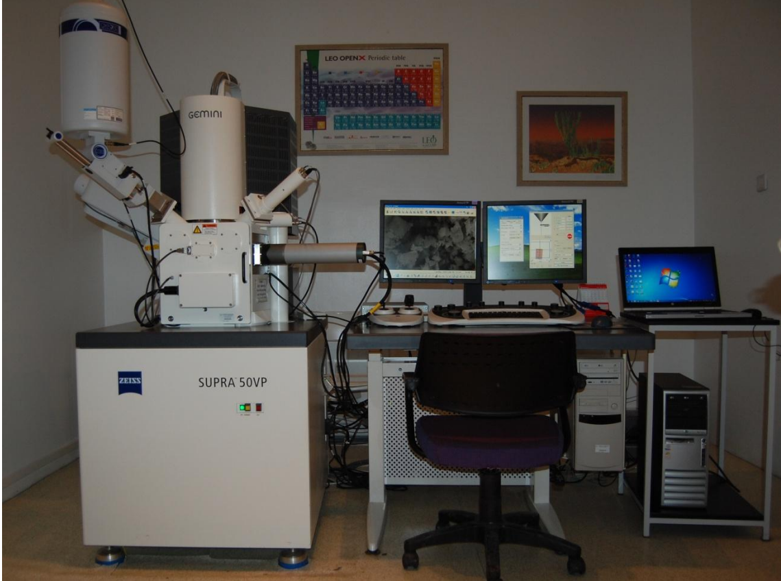
Şekil 4.15 “Zeiss SUPRA 50VP” marka ve model taramalı elektron mikroskop ve beraber çalışan “EBSD-Oxford Instruments INCA Energy” model EDX - WDX detektörü
