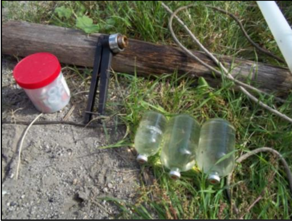
Şekil 1.3 Suda çözünmüş gaz örnekleme malzemesi
