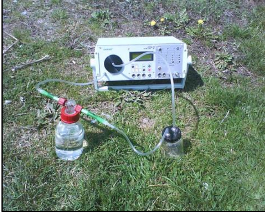
Şekil 1.2 GEO-RTM radon cihazı ve aparatları
