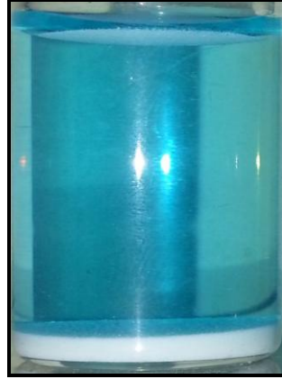
Şekil 4.5. Bakır ile kompleks oluşturmayan yalın haldeki PSGMA lateks örneği
