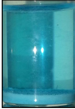
Şekil 4.4. Bakır ile kompleks yapan borik asit yüklü lateks örneği
