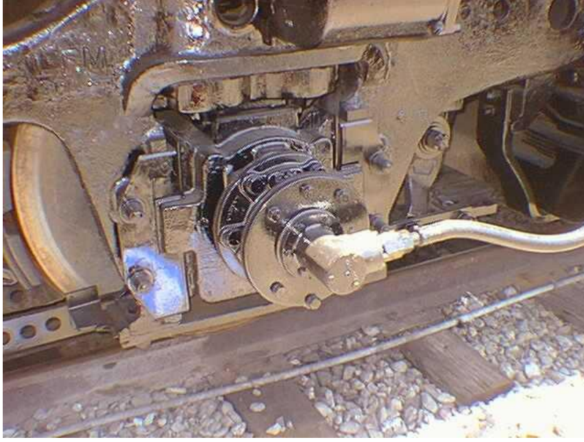
Şekil 3.2. Kabine bağlı bir odometre çıkışı (Anonim, 2014)
