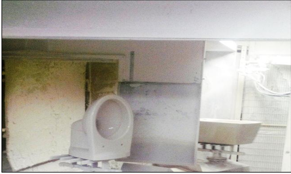
Şekil 3.10. Sırlama Robotu ile Klozetin Sırlanma İşlemi
