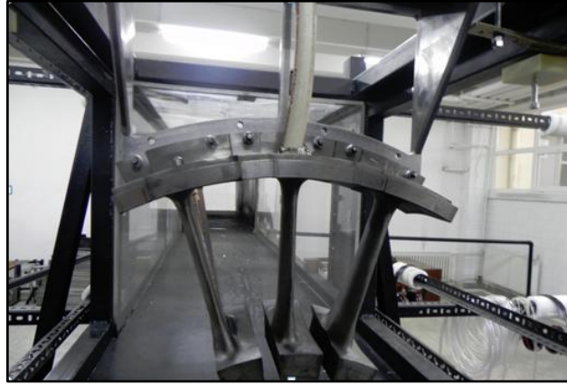
Şekil 6.5. Kanatların deney düzeneğine yerleştirilmesi
