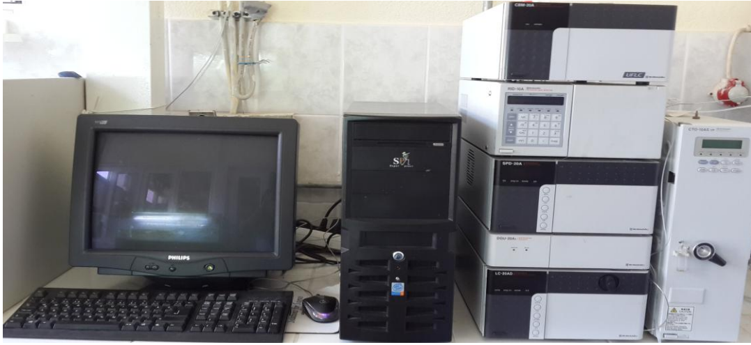
Şekil 3.9. Analizler boyunca kullanılan HPLC cihazı
