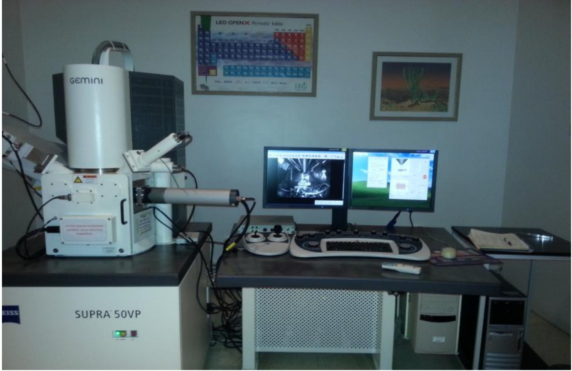
Şekil 9.7. Numunelerin elementel kimyasal analiz işlemlerinde kullanılan x-ışınları spektrometresi(EDS) donanımlı taramalı elektron mikroskobu (SEM).
