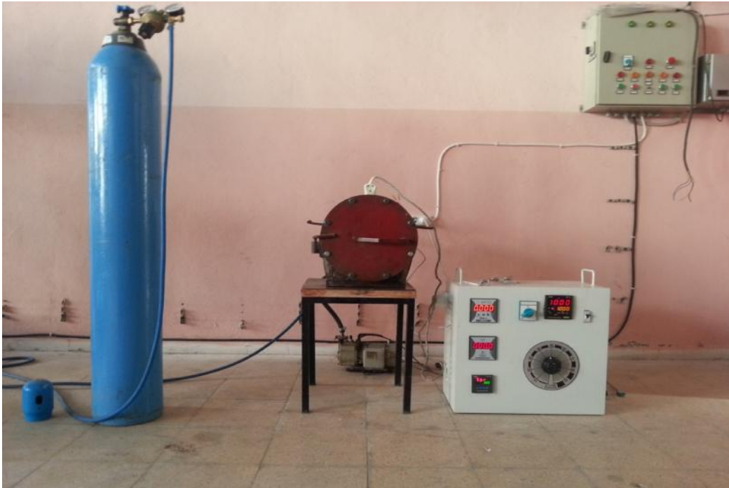
Şekil 9.2. Sementasyon işlemlerinin gerçekleştirildiği fırın düzeneği.
