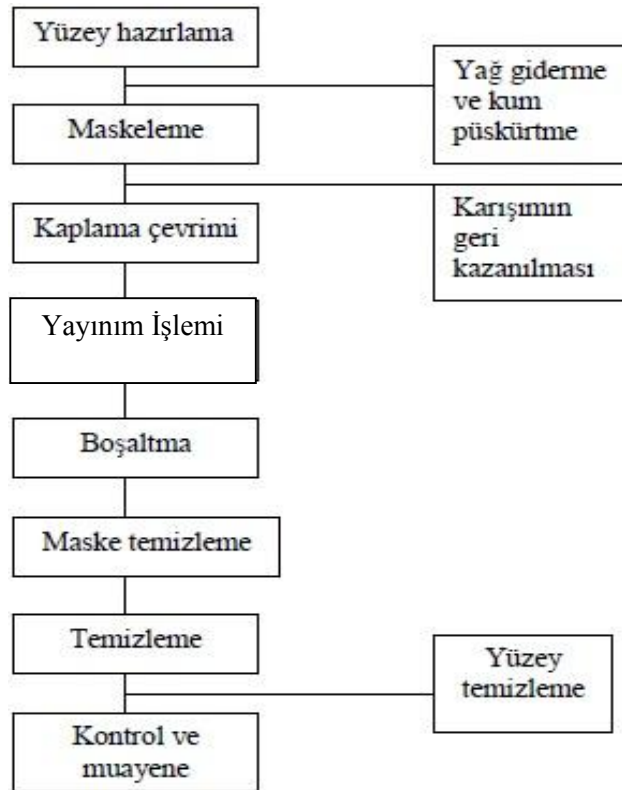
Şekil 8.4. Kutu alüminyumlama da işlem sırası (Yılmaz, 2008).
