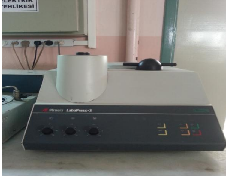
Şekil 9.3. Enine kesiti alınmış numunelerin bakalit kalıba alınması işleminde kullanılan cihaz.
