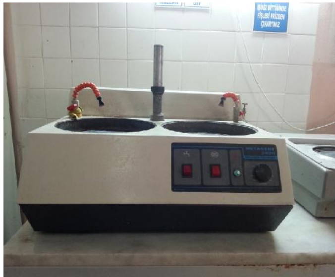
Şekil 9.4. Numunelerin parlatma ve zımparalama işlemlerinde kullanılan cihaz.
