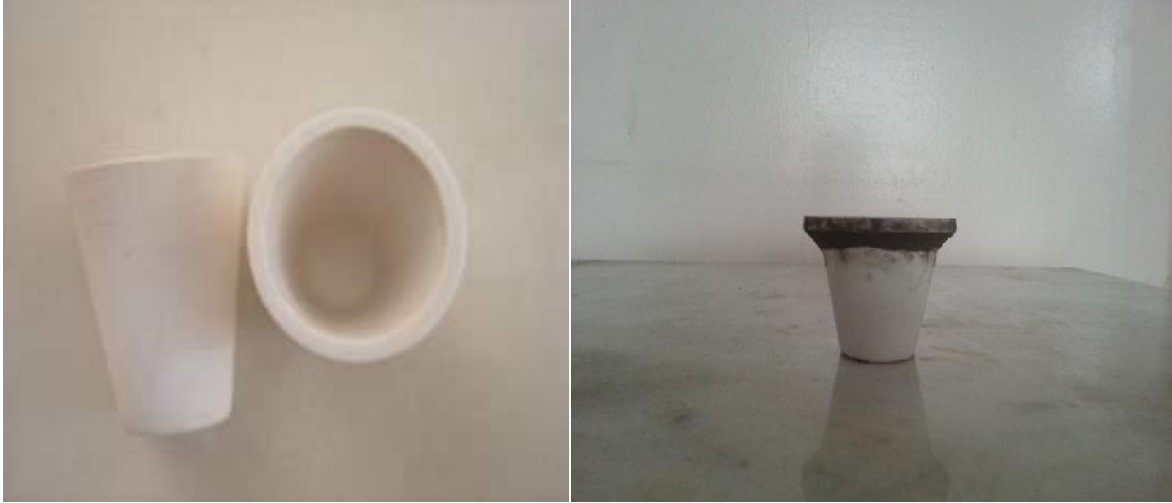
Şekil 9.10. Alüminyumlama işlemlerinde kullanılan pota boş hali(solda), numune koyulup ağzı şamotlandıktan sonraki hali (sağda).
