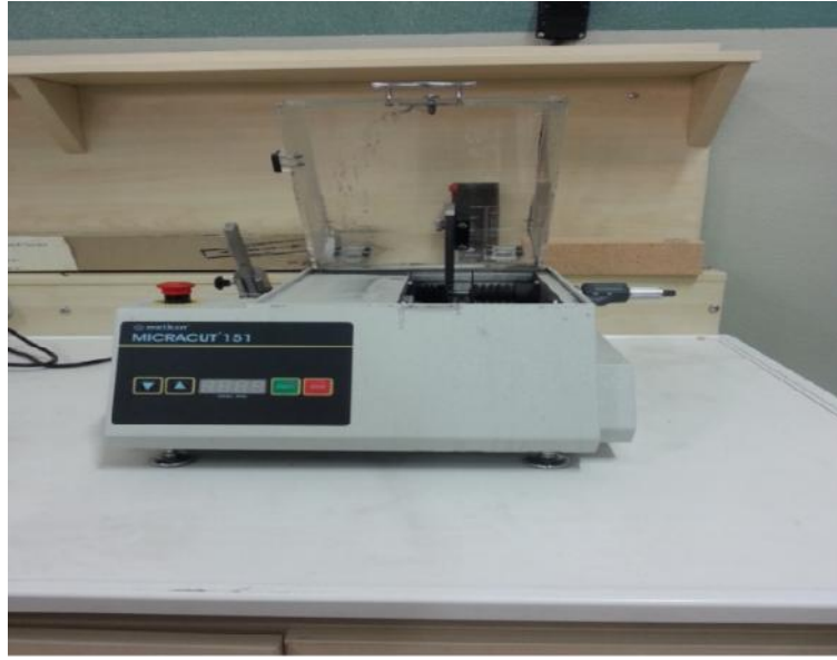
Şekil 9.1. Numunelerin kesme işlemlerinde kullanılan cihaz.
