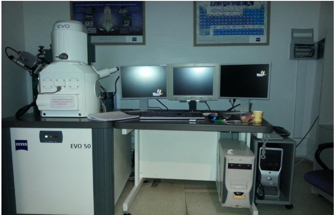
Şekil 9.8. Numunelerin çizgisel analiz ve haritalama işlemlerinde kullanılan taramalı elektron mikroskobu (SEM).
