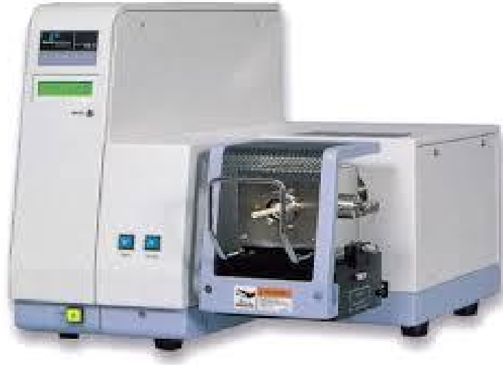
Şekil 9.9. Yüksek sıcaklık gaz korozyonu özelliklerinin tespitinde kullanılan termogravimetri cihazı.
