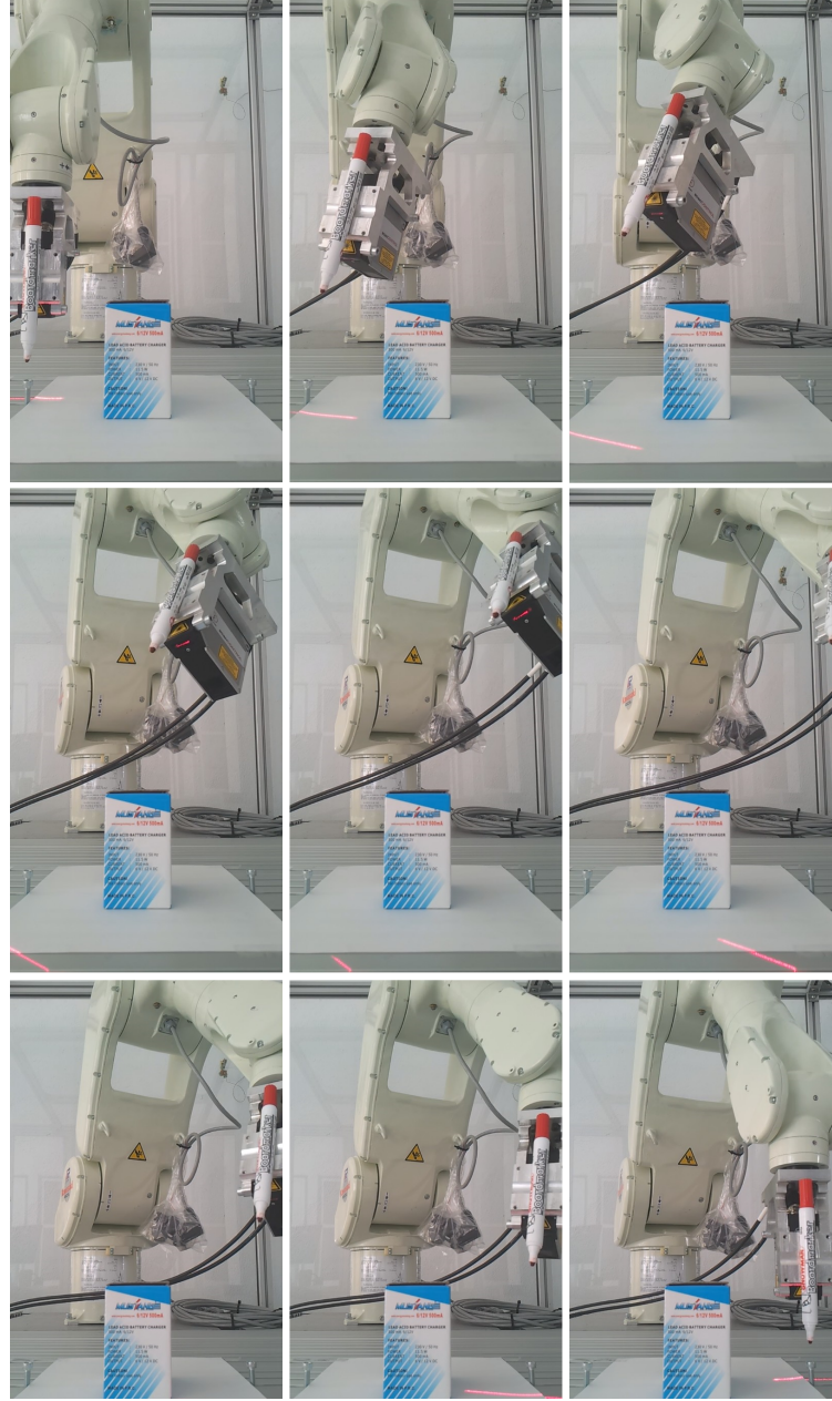
Şekil 5.12: Hareket Planlama Testinin Engel İçeren Senaryosunun Gerçekleştirildiği Süreçte Sırayla Alınan Görüntüler
