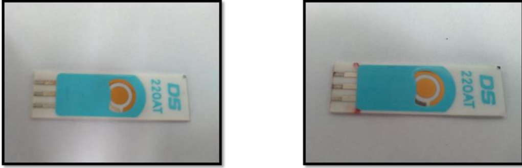
Şekil 4.31. SPGE'nin 1.rejenerasyon (sol) ve 2. rejenerasyon (sağ) prosedürü sonrası görüntüleri.
