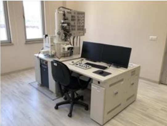
Şekil 3.15. Alan Emisyonlu SEM cihazı (ARUM, ESOGU)
