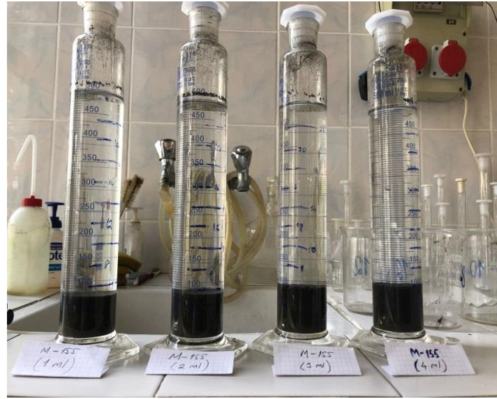
Şekil 5.9. Mezürde flokülasyon deneyi ve arayüzey yüksekliği ölçümü
