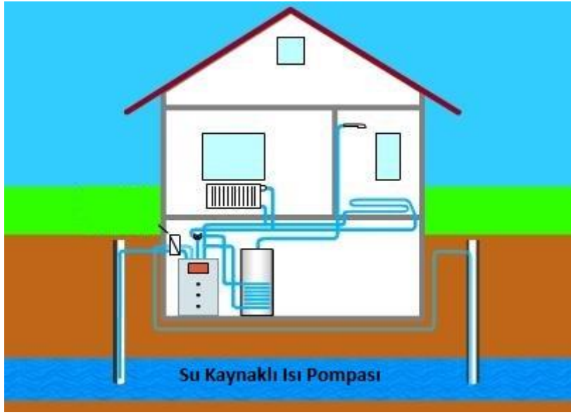
Şekil 4.8. Su kaynaklı ısı pompası şematik gösterimi (Anonim,2021).
