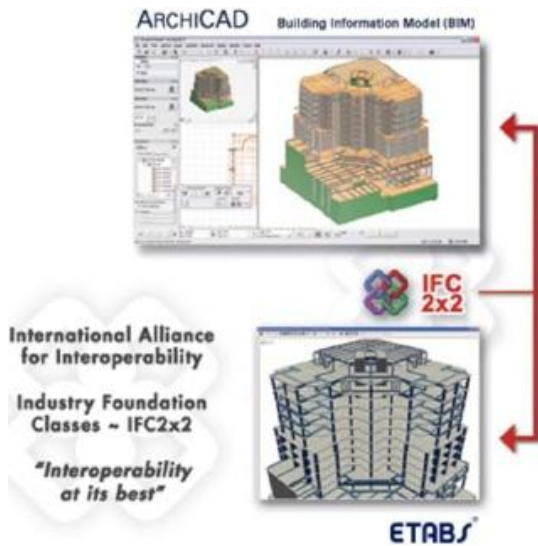
Şekil 2.8. Graphisoft ArchiCAD™ ve ETABS™ yazılımları arasında IFC üzerinden veri alışverişi (Ofloğlu,2009)
