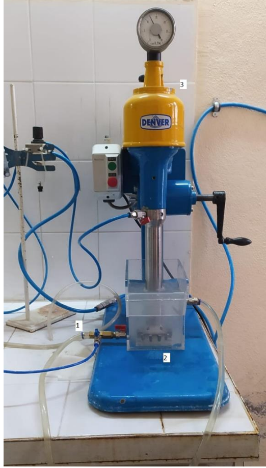
Şekil 3.3. Modifiye hücre flotasyon deney düzeneği (1- Mikro-kabarcık üretici, 2- Kare kesitli flotasyon hücresi 3- Flotasyon makinası)
