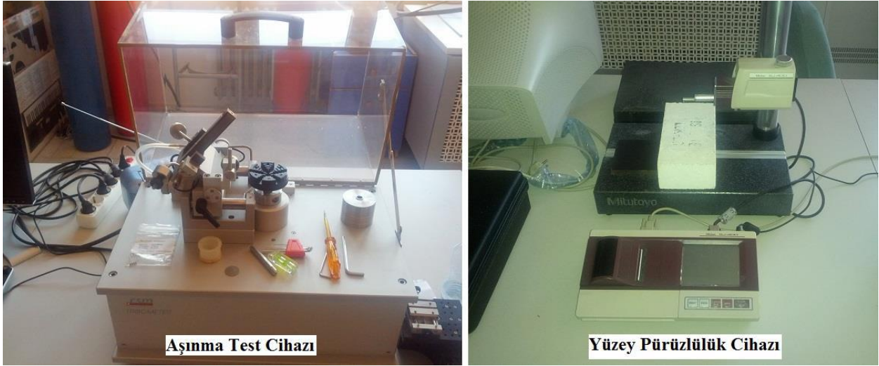
Şekil 7.9. CSM Tribometer aşınma test cihazı ve Mitutoyo SurfTest SJ-400 yüzey pürüzlüğü ölçüm cihazı.
