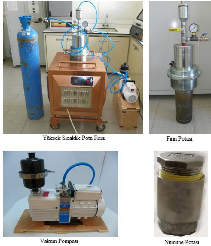
Şekil 7.5. Termo reaktif kaplama prosesinde kullanılan yüksek sıcaklık pota fırını, fırın potası ve vakum pompası
