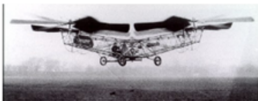
Şekil 2.3 Dr. George De Bothezat Dört Pervaneli Hava Aracı Tasarımı
