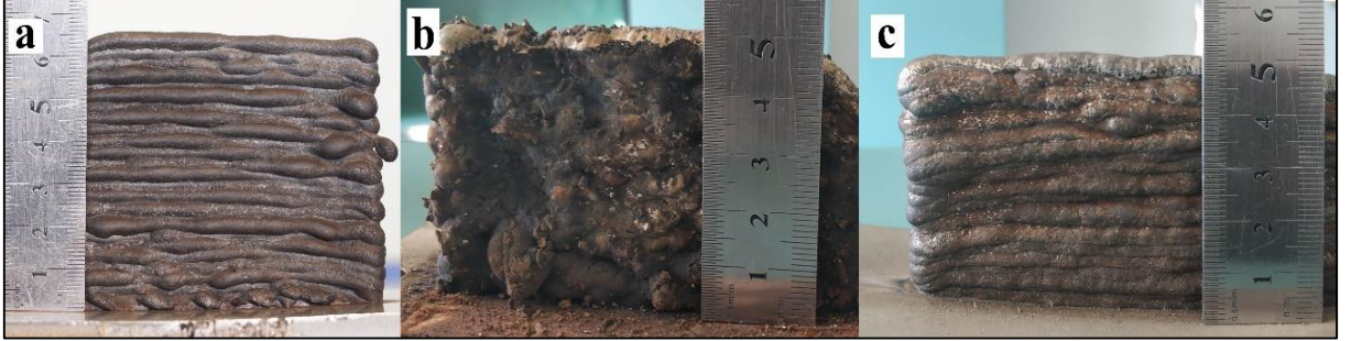
Şekil 6.3 P-TAKİ yöntemi ile üretilen malzemeler, a) 304 paslanmaz çelik malzeme, b) SiC takviyeli malzeme, c) FeCrC takviyeli malzeme
