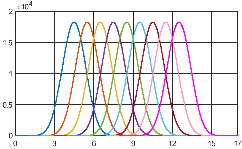
Şekil 4.51. Sekizinci dereceden B-spline fonksiyonları
