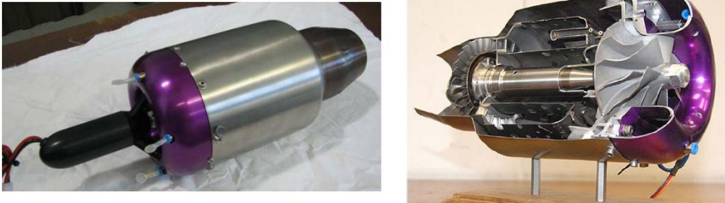
Şekil 8.1. AMT Olympus HP gaz türbin motoru ve kesiti
