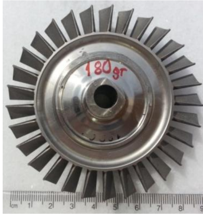
Şekil 8.2. Olympus HP gaz türbin motoru türbin çarkı
