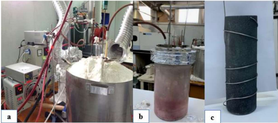
Şekil 5.1. (a) Elektro-deoksidasyon deney tasarımı b) Hücre görüntüsü c) Pota görüntüsü.
