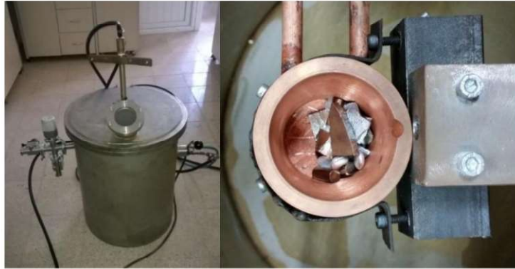
Şekil 4.1. Vakum ark ergitme ocağı ve su soğutmalı bakır pota.
