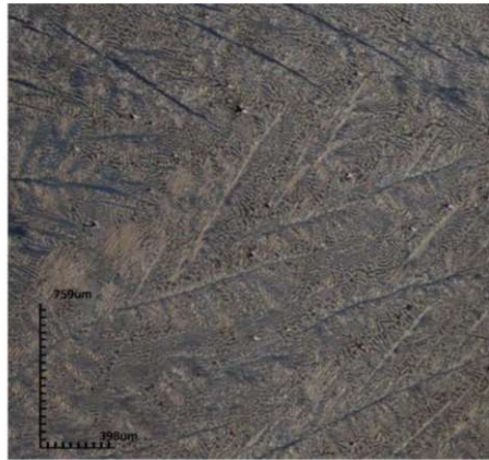
Şekil 3.2. AlCoCrFeNi_{2.1} ÖYEA'ına ait mikroyapı görüntüsü (Lu vd., 2014).
