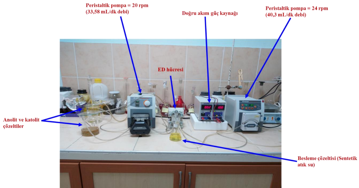
Şekil 6.1 ED sistemi deney düzenegi.
