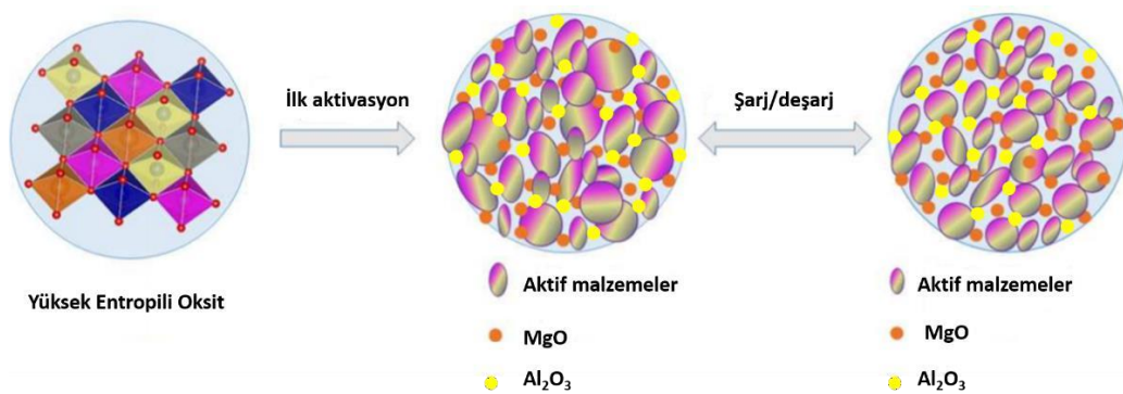
Şekil 3. 4. Yüksek entropili oksit anodun şarj-deşarj mekanizması.
