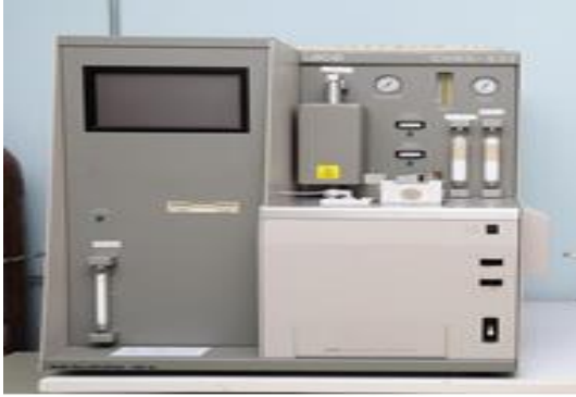
Şekil 5.3.LECO CHNS-932 Elementel Analiz Cihazı
