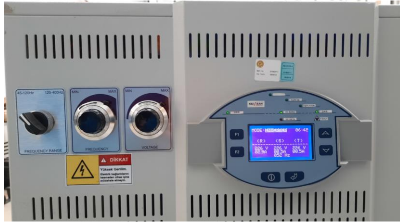
Şekil 5.2 AC Güç Kaynağı
