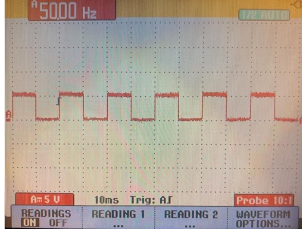
Şekil 3.23 J2-2 ve J2-3'den Alınmış Osiloskop Görüntüsü (Frekans Örnekleme Çıkışı)
