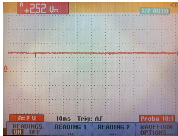
Şekil 3.24 J1-1 ve J1-2'den Alınmış Osiloskop Görüntüsü (Gerilim Örnekleme Çıkışı)
