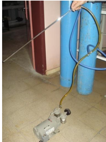
Şekil 5.4. Pelet numunelerin argon atmosferinde kuvars cam içine konulması için hazırlanmış düzenek.
