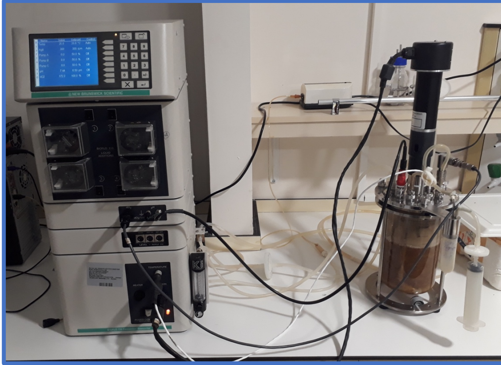
Şekil 3.2. Laboratuvar ölçekli fermentör (Bioflo 110, New Brunswick Scientific, USA)
