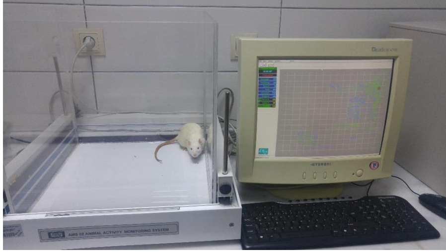
Şekil 3.1 Aktivitemetre testi düzeneği
