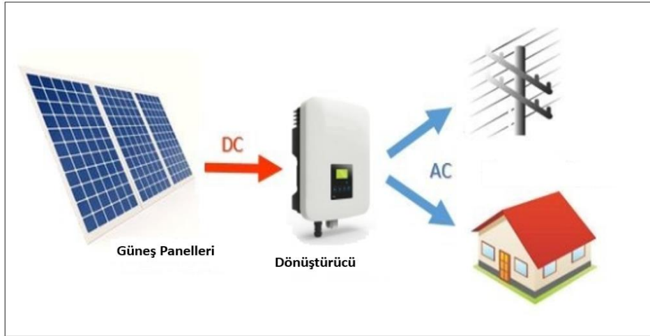
Şekil 3.17. Şebeke bağlantılı fotovoltaik sistem mimarisi (Newkirk, M. 2016)
