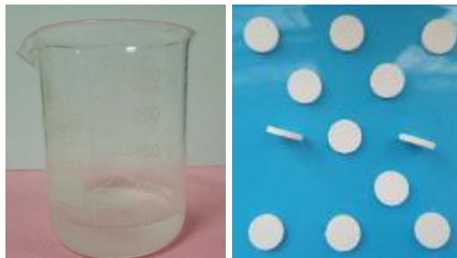
Şekil 4.2. Şeffaf jel halinde katılaştıran sol, oluşturulan biyoaktif cam tabletler
