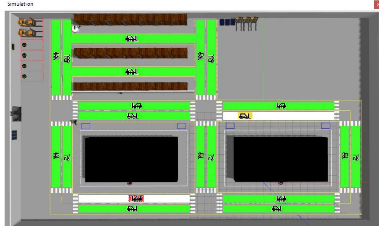
Şekil 4.3. C# Uygulaması simülasyon ortamında farklı yol parçalarında tespit edilen araç kaynaklı bilinmeyen ve yavaşlama anomalileri (Örnek vd.'den, 2018)
