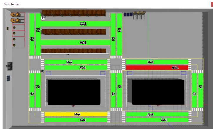
Şekil 4.2. C# Uygulaması simülasyon ortamında farklı yol parçalarında tespit edilen durma ve yaya yoğunluğu kaynaklı yavaşlama anomalileri (Örnek vd.'den, 2018)
