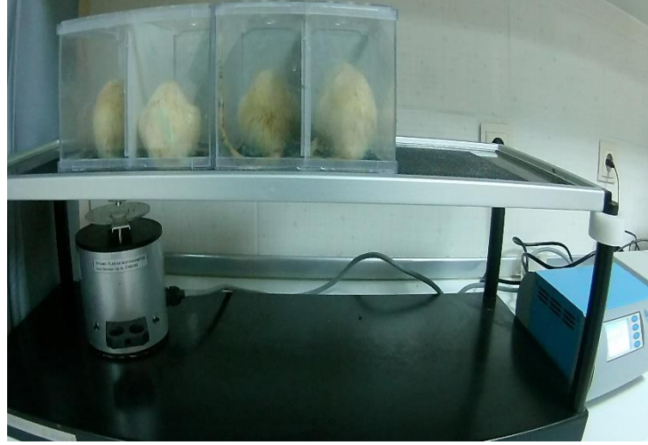
Şekil 3.2 Dinamik plantar test düzeneği.
